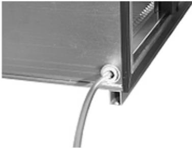
Der Tauwasserschlauch des Verdampfers ist seitlich aus dem Korpus heraus geführt und bauseitig an einen Bodenablauf oder eine Tauwasserverdunstung durch autorisiertes Fachpersonal anzuschließen. Es sollte bauseitig ein Siphon außerhalb des Kühlmöbels installiert werden, wenn der Tauwasserschlauch an eine bauseitige Abwasserleitung angeschlossen wird.
